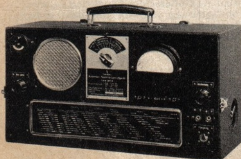
Antennenspannungsmeßgerät SAM 305 W, das z. B. zur Ausrüstung jedes Siemens-Antennenspezialisten gehört und zur hochfrequenzmäßigen Überprüfung der fertiggestellten Antennenanlagen dient
