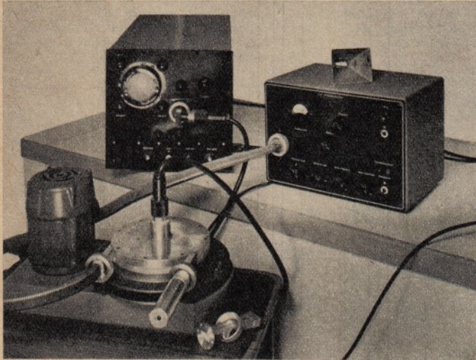
UKW - Meßplatz von Rohde & Schwarz, rechts außen Impedanzmesser mit einer Anzeigscheibe aus Mattglas mit mehreren auswechselbaren Diagrammen
