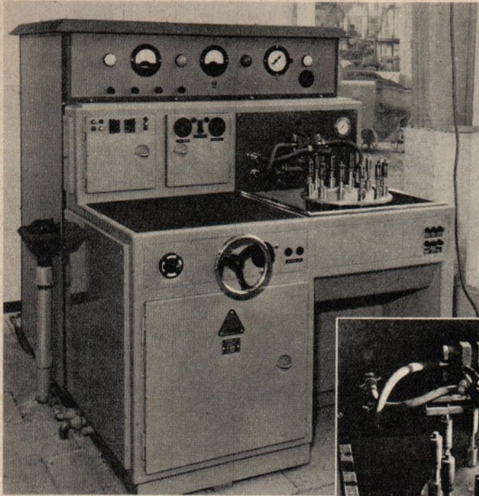
HWG-Induktions-„Maschine“ der Firma Hochfrequenzwärme Schmidt & Co, Gesellschaft für Induktionsanlagen mbH, Reichenbach-Fils, mit HF-Teil der Elektro-Spezial GmbH. Die Aufnahmen zeigen die Härtung kleiner Stahllwellen
